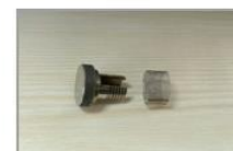
3. Извлечь экран после вывертывания винта.
