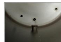
6. Повернуть винт сита вправо вниз, как показано на рисунке, так, чтобы сито плотно прилегало к нижней стенке камеры стерилизатора.
